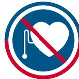
**Starke Magnetfelder können elektrische und elektronische Geräte bzw. Datenträger beeinflussen; Magnete nicht in die Nähe von Herzschrittmachern, Datenträgern, Navigationsgeräten, Scheckkarten etc. bringen!**
